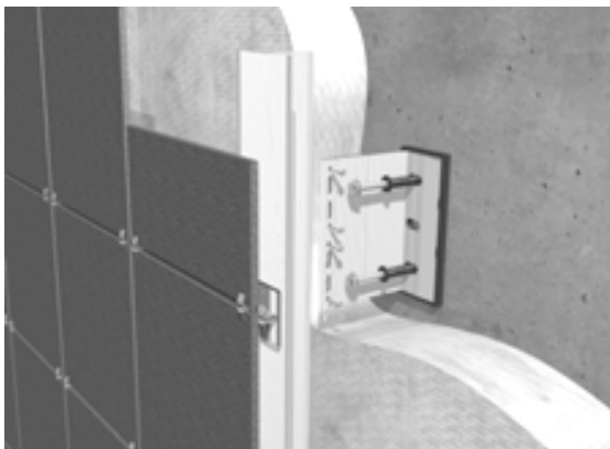
تصویر ۱: مدل ساده شده ای از نمای تهویه شونده با درز باز
