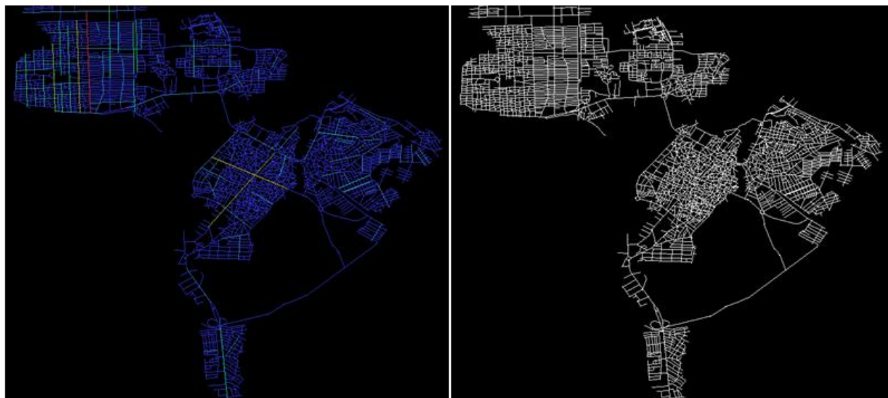
شکل ۱۰: نقشه‌ها مربوط به شوشتر ۱۴۰۳ از راست به چپ؛ نقشه Axial Map خروجی نرم افزار UCL Depthmap از نقشه خطوط محوری، نقشه خطوط محوری خروجی نرم افزار UCL Depthmap. ترسیم دستی با استفاده از نرم افزار Auto Cad است (ماخذ: نگارندگان)
