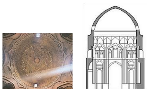
تصویر ۷: گنبد یک پوسته گنبد تاج الملک مسجد جامع اصفهان. مقطع گنبد (Ashkan, 2009, 103). و نمای زیر گنبد (حاجی قاسمی، ۱۳۷۵، ۶۳).
