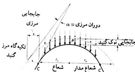
تصویر ۱: تغییر شکل گنبد کروی با خیز کم (سالوادوری، ۱۳۸۲، ۲۵۶)
