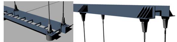
شکل ۹) راست: لچکی ها برای تقویت نبشی ها در محل اتصال کابل ها؛ چپ: استوانه تنظیم کننده طول کابل ها. (ترسیم: نگارندگان)
