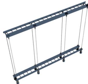
شکل ۱۰) جزئیات قرارگیری عناصر مقاوم سازی (ترسیم: نگارندگان)
