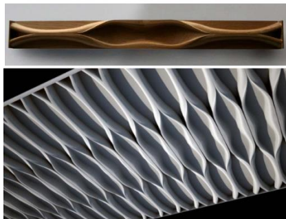
شکل ۶) اسلب سقف فرم یابی شده به وسیله بهینه سازی
