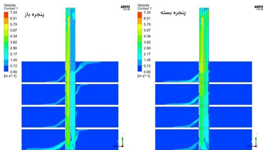
شکل ۱۱- سرعت جريان در بادگیر ۴ طرفه در دو حالت پنجره باز و بسته
