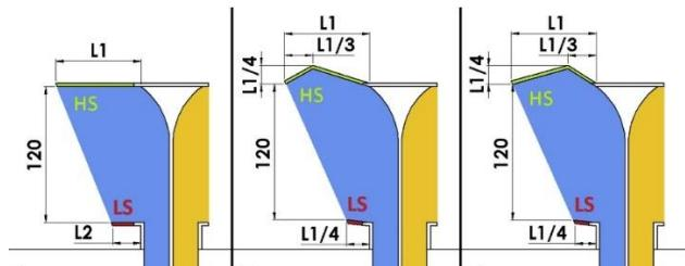
شکل ۲- بررسی نمونه های مختلف پسوند دهانه ورودی برج بادگیر [۴۳]
