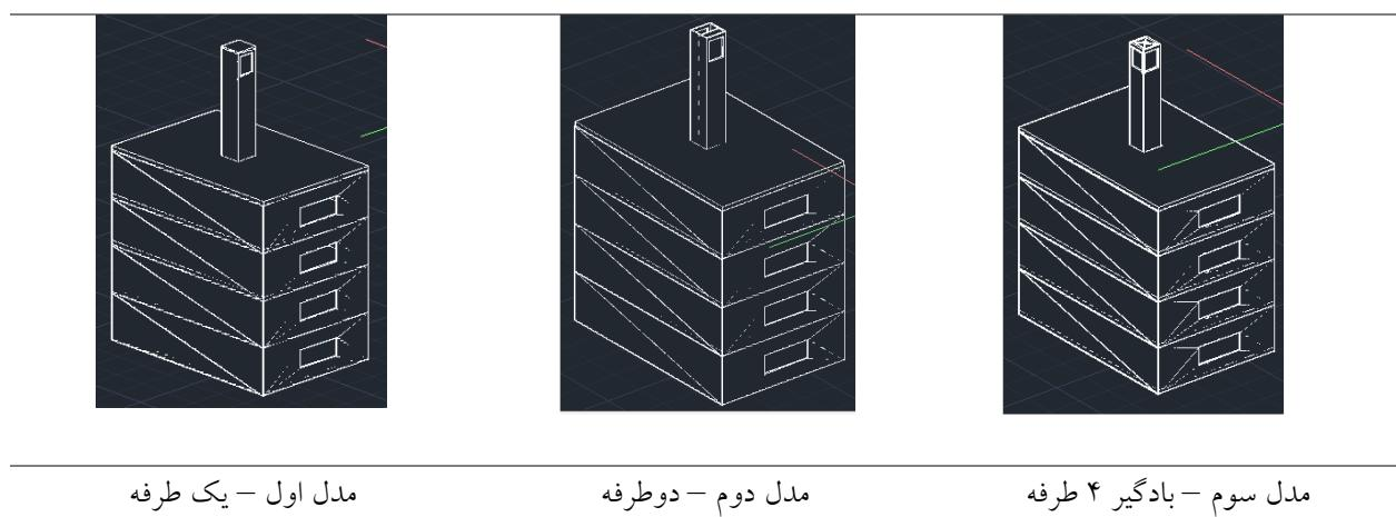
شکل ۴- طرح سه بعدی مدل های متفاوت بادگیر با جانمایی و ارتفاع یکسان در ساختمان نمونه
