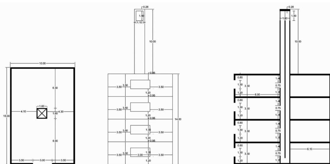
شکل ۵- مدل طراحی شده جهت آنالیز در نرم افزار فلوینت (پلان و نما و سطح مقطع - واحد: متر)
