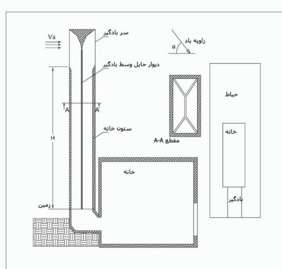
شکل ۱- رفتار یک بادگیر دو سویه در یک خانه سنتی. [۳۶]
