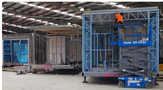
شکل شماره ۱. ساخت مدول‌های پیش‌ساخته در کارخانه [۳۵]
